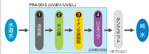
※本装置は、運転信号の入力を受けて作動します。オプション品のタンクユニットや、外部タンク水位スイッチ、運転信号ケーブルを使用し運転を制御します。
