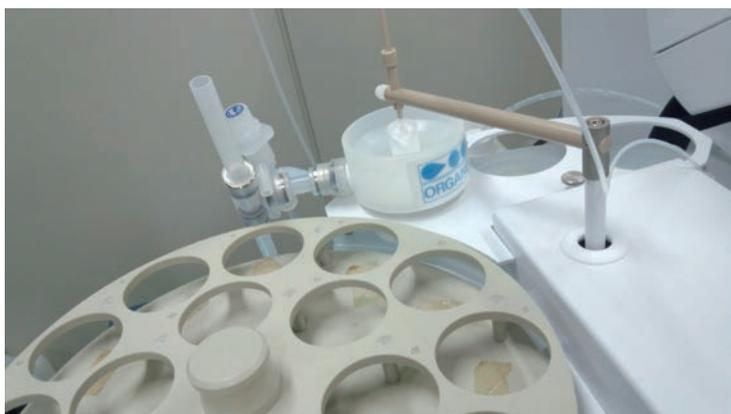
アジレント・テクノロジー製 ICP-MS に取り付けられたリンスポート
