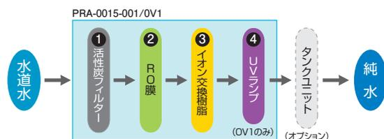
※本装置は、運転信号の入力を受けて作動します。オプション品のタンクユニットや、外部タンク水位スイッチ、運転信号ケーブルを使用して運転を制御します。
